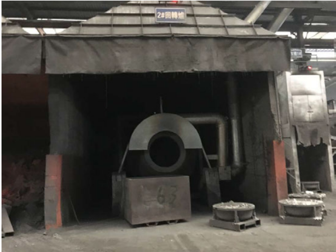
回转炉炉门强化收集措施（部分示意）
