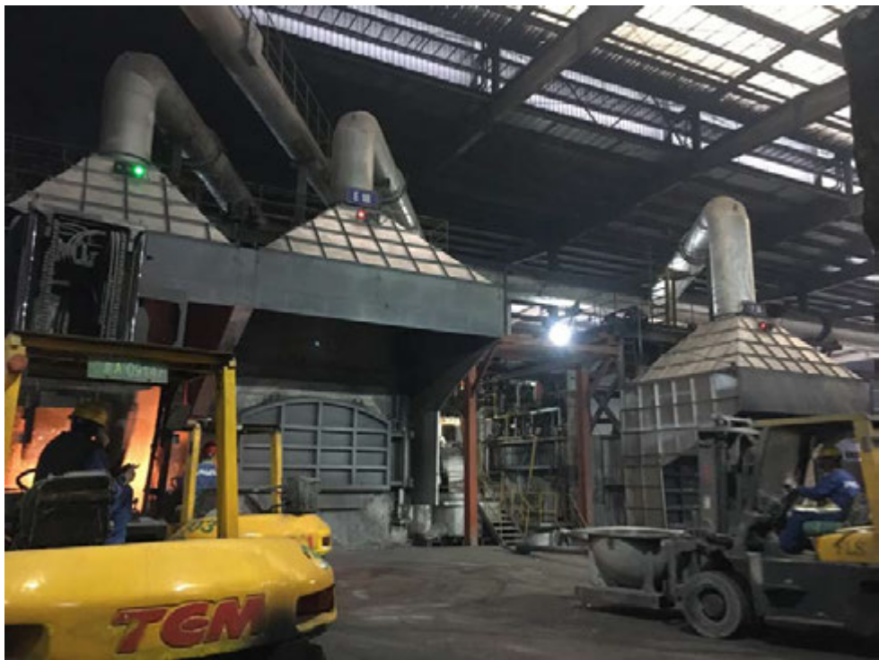
2#线熔炼炉集气罩（部分示意）
