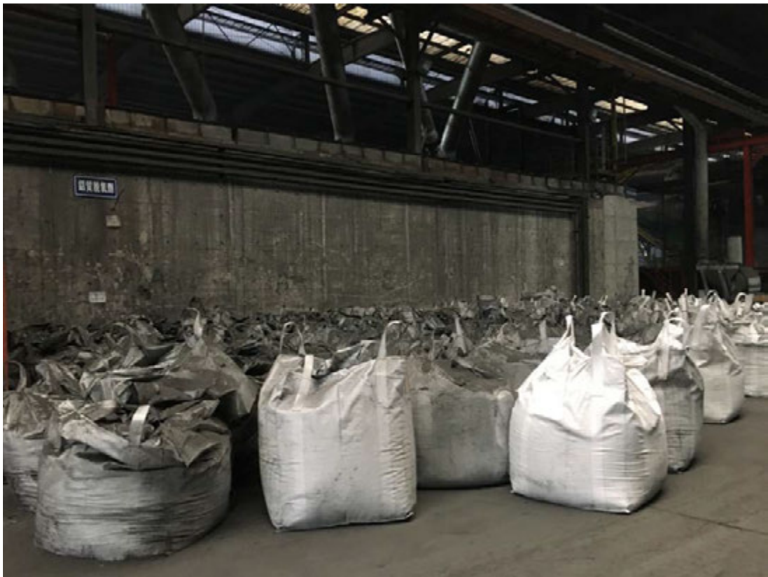
厂区一般工业固体废物暂存区（铝灰渣）
