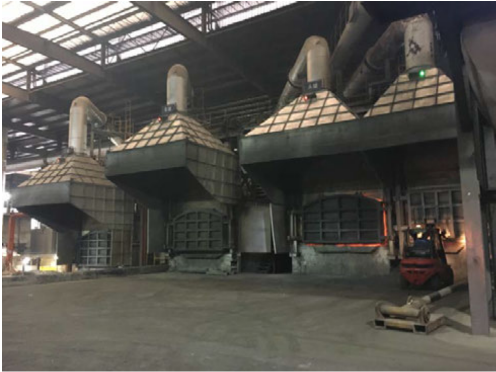
1#线熔炼炉集气罩（部分示意）
