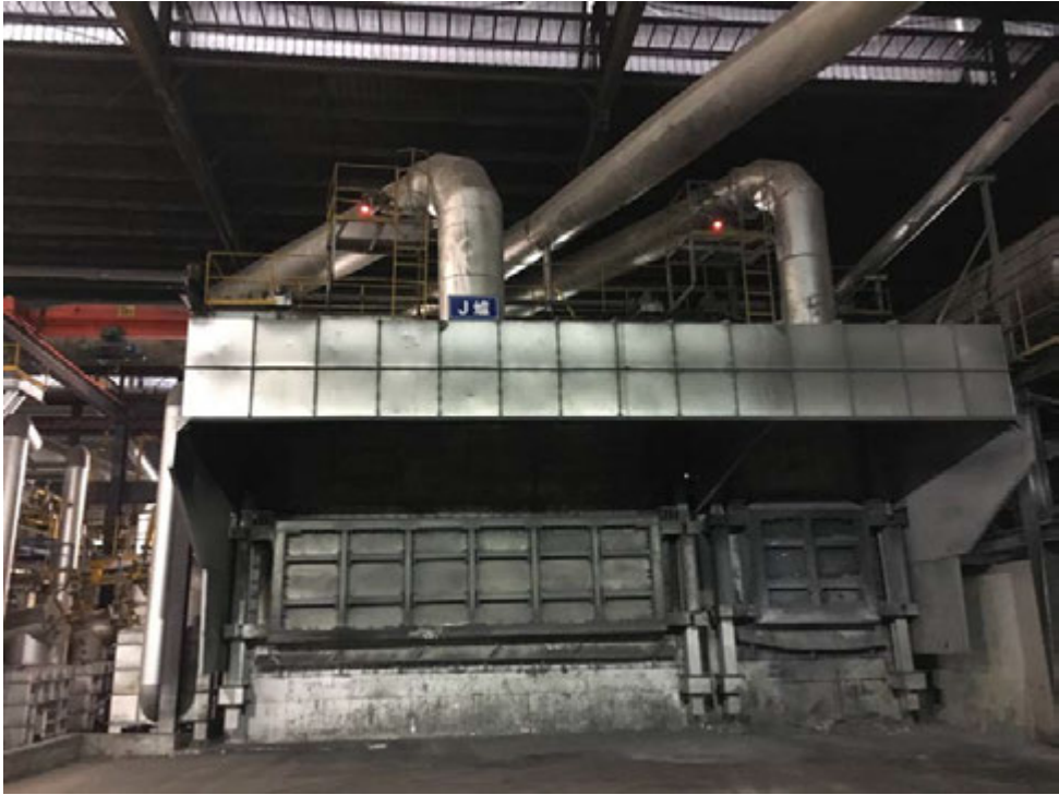
3#线熔炼炉集气罩（部分示意）
